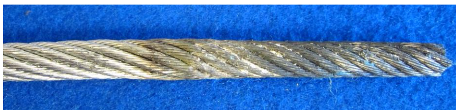
Seilende mit Schweissbrenner ausgeglüht und verdreht
